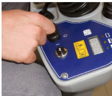
13. Выключите машину, повернув ключ зажигания в положение "0".
