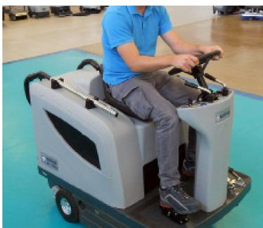
7. Управляйте машиной, держа руки на рулевом колесе и нажимая педаль на передней стороне, чтобы двигаться вперед, и на задней стороне, чтобы двигаться назад.
