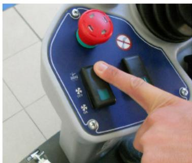
11. Чтобы очистить фильтр, включите шейкер фильтра, нажав переключатель в течение нескольких секунд.
