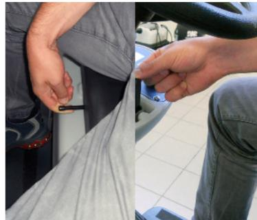
4. Отрегулируйте сиденье с помощью рычага. Используйте рычаг, чтобы наклонить рулевое колесо в удобное положение.
